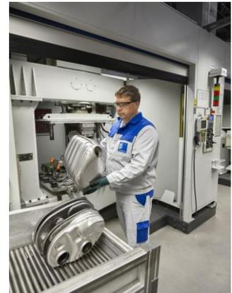
Sichtprüfung während der Pkw-Schalldämpfer-Produktion im Werk Neunkirchen
